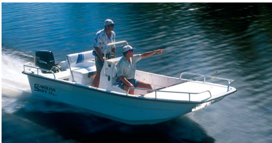
“Carolina Skiff 17 DLX”: длина — 5.1 м, ширина — 1.95 м, высота транца — 0.51 м, вес — 340 кг, грузоподъемность — 640 кг, пассажироместимость — 8 чел., макс. мощность ПМ — 75 л.с.
