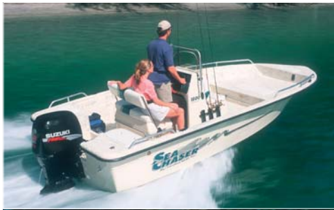
“Sea Chaser 1800 Roll Gunnel”: длина — 5.49 м, ширина — 2.42 м, высота транца — 0.51 м, вес — 703 кг, грузоподъемность — 680 кг, пассажировместимость — 5 чел., макс. мощность ПМ — 115 л.с.
