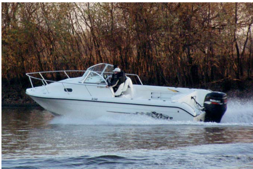
“Sea Chaser 2400 WA Offshore”, представленный на дилерской встрече в Астрахани: длина — 7.32 м, ширина — 2.61 м, высота транца — 0.63 м, вес — 1584 кг, грузоподъемность — 1040 кг, пассажироместимость — 8 чел., макс. мощность ПМ — 300 л.с.
